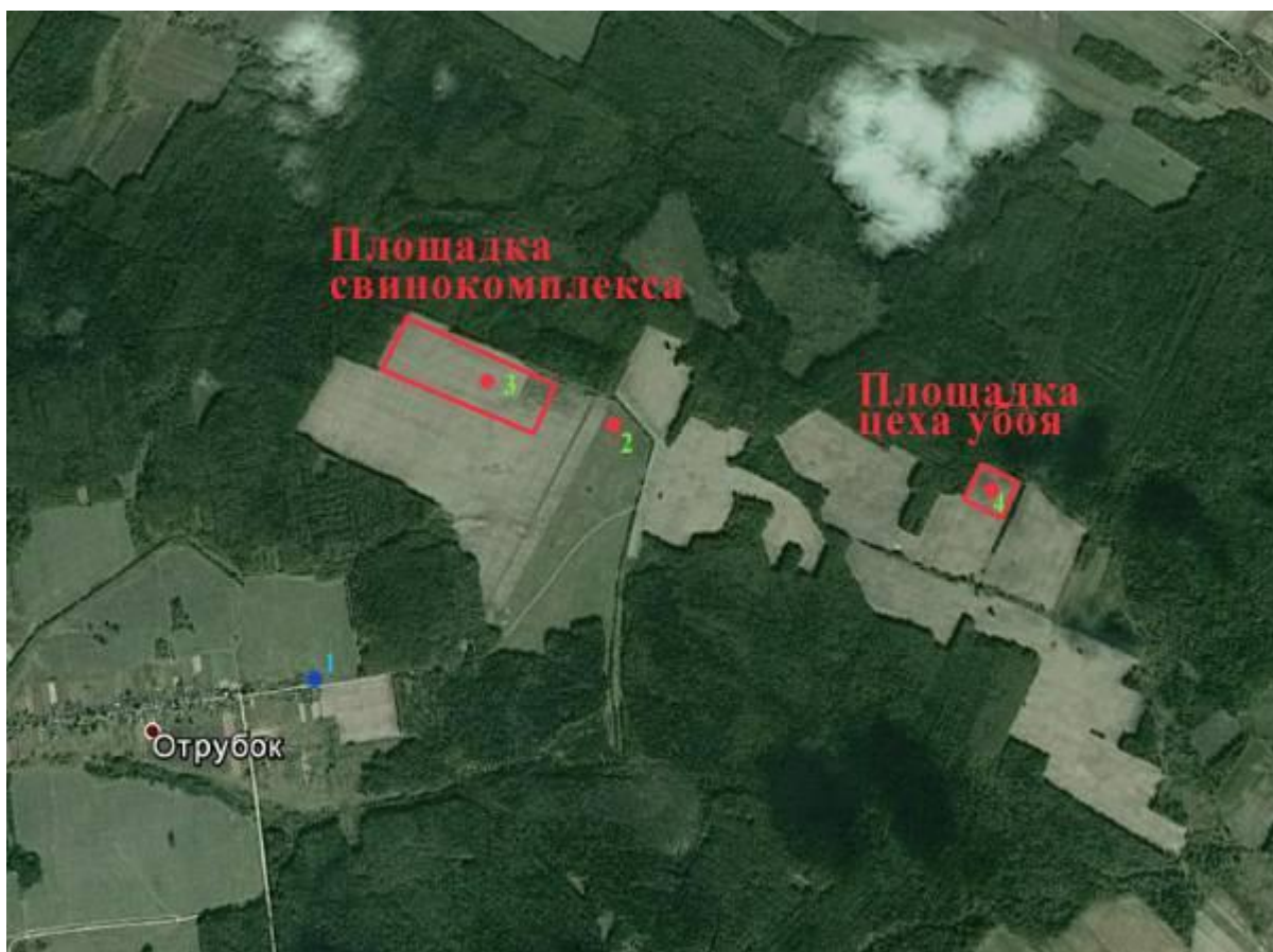
Рисунок 18 – Схема отбора проб почв и воды в районе д. Отрубок (красный цвет – почвы, синий - вода)
